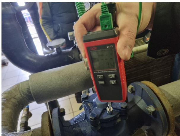
Рисунок 19 (образование конденсат на неизолированной поверхности оборудования.)
